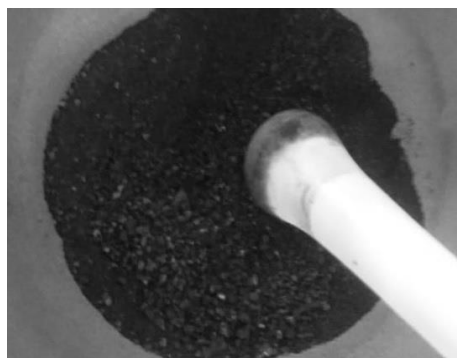
Figura 1: óxido de Grafeno obtenido del mesocarpio de Cocos nucifera , mediante método Hummers.
